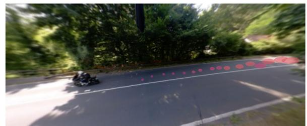
Visualisation de la trace acoustique générée par un véhicule deux-roues motorisé.
