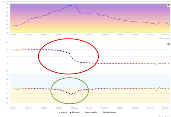
En projetant ensuite ces « niveaux localisés » sur une visualisation à  $360^\circ$ , il devient alors possible de « voir » la trace acoustique générée par le véhicule.
